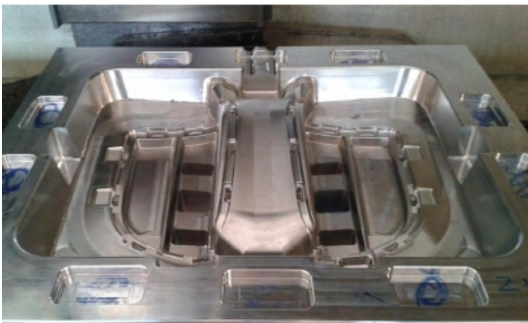
Stampo in acciaio bonificato "Grigia posteriore Miniminor"
